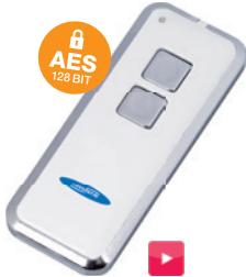
Mini-Novotron 522 Design* 2-Kanal, 433 MHz, KeeLoq-Wechselcode
